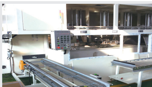
탄화수소 세척기 Hydrocarbon washer
